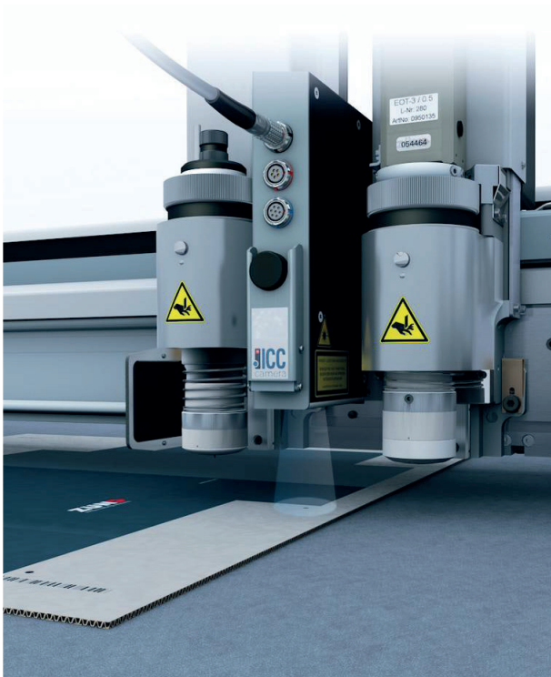
↑ Řezací hlava plotru (Zünd G3) s laserovým nástavcem a ICC kamerou.
